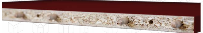
Spoj kolík BK 8x35 mm a otvor pro excentr Minifix 15 Häfele
